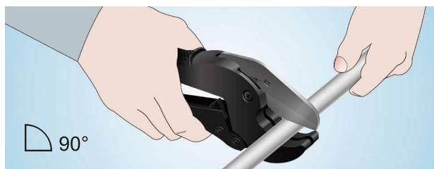
1. Отрежьте трубу под прямым углом
